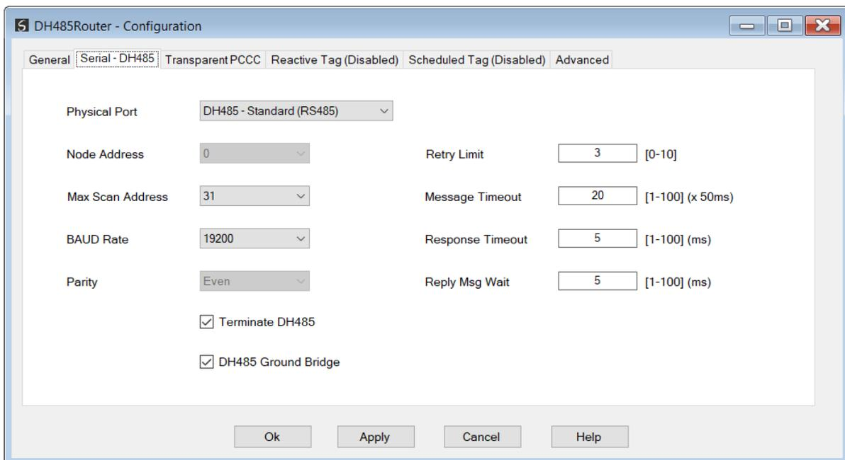
Figure 3.18 - Serial DH485 configuration
