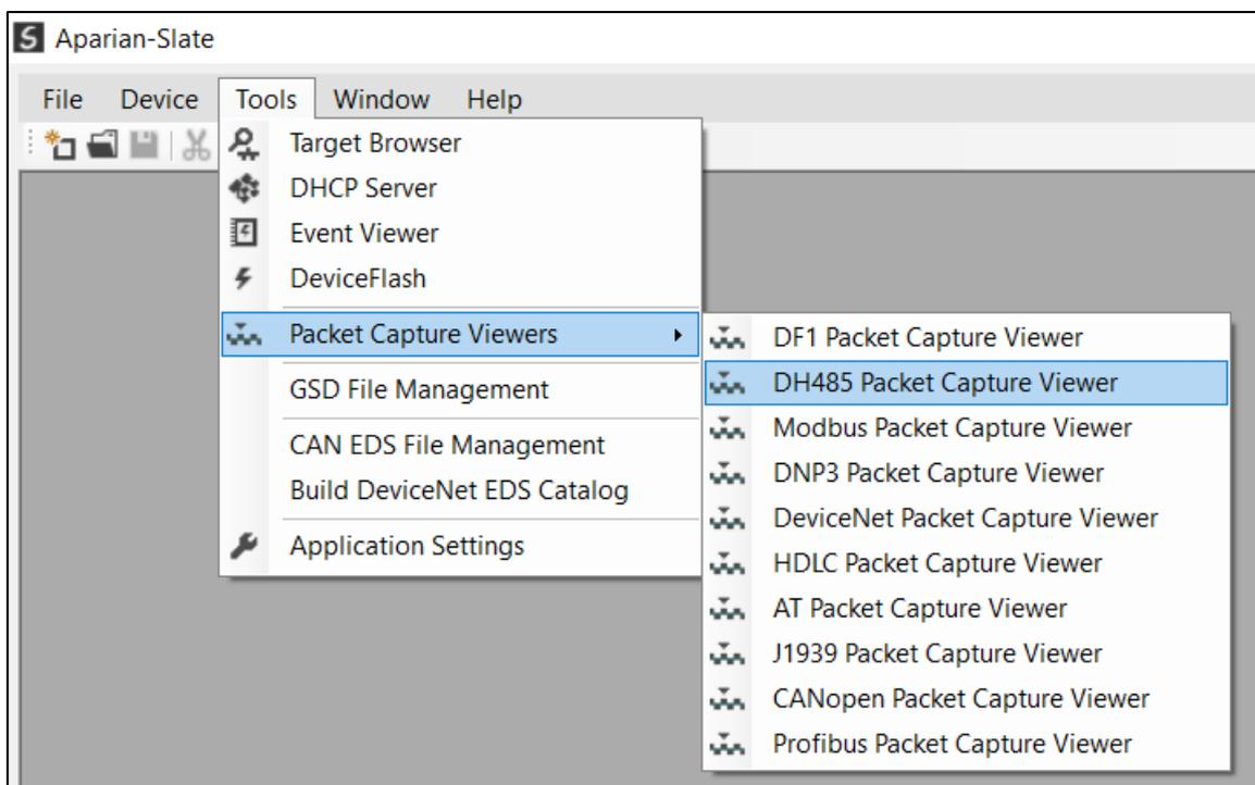
Figure 5.13. - Selecting the DH485 Packet Capture Viewer
