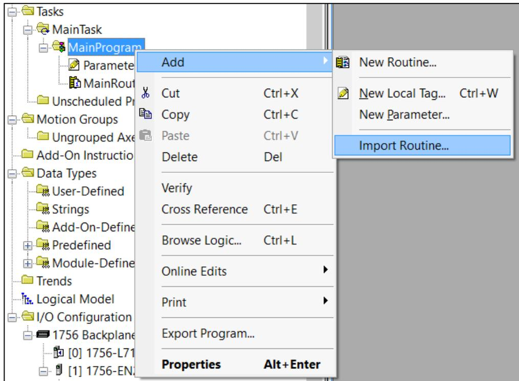
Figure 3.52 - RSLogix 5000 Importing DH485Router specific routine and UDTs
